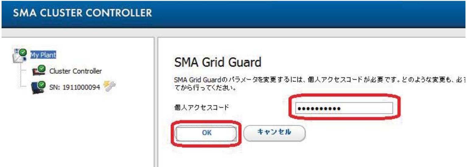
6. 左側ツリーの『My Plant』を選択し、『設定』タブを選択することで1回の操作で同じネットワークに所属する全 PCS の整定値変更が可能です。以下の図では整定値設定変更に関連する部分の概要を案内しています。
