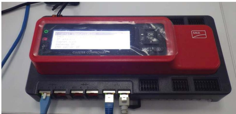
2. クラスターコントローラーの方向キー『▼』を数回押して画面を変え、IP アドレスが表示されている『External communication』の画面にてインターネットルーターより DHCP にて割り当てられた IP アドレス及びサブネットマスクを確認します。(本マニュアルでは IP アドレスが 192.168.11.59、サブネットマスクが 255.255.255.0 になります)
