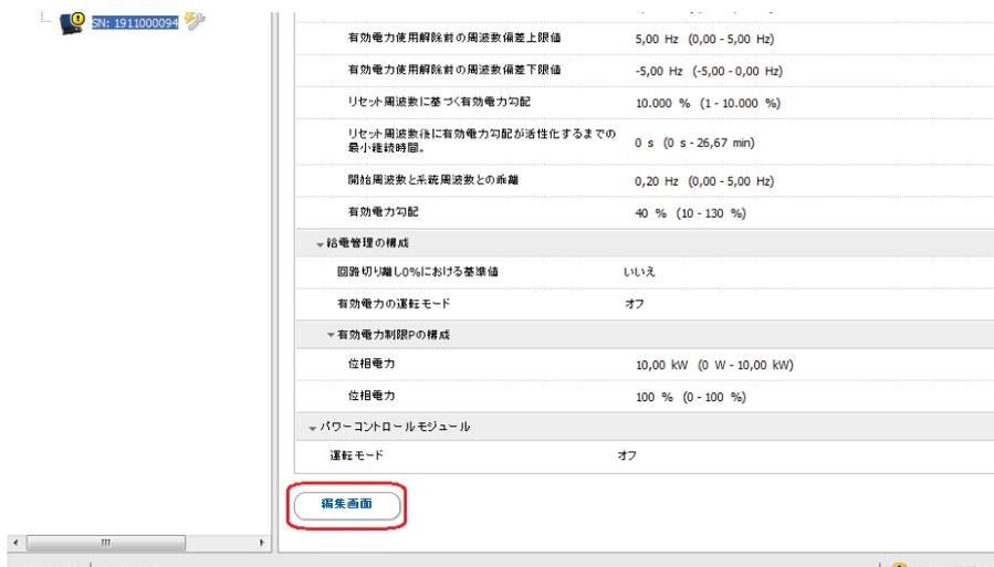
7. 『静的電圧安定化の運転モード』の『無効電力特性曲線モード』を『cos Phi,直接規定値(0)』に変更し、『cos Ph の規定値』に電力会社より指定された力率の値を入力します。また、『cos Ph の励起方式』が『進み』になっていることを確認します。設定終了後、一番下にある『保存』をクリックします。
