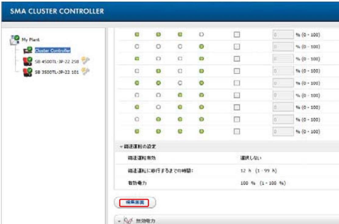
12. 「基本設定」の「信号源」にて「デジタル信号入力」を選択し、緑色の枠内を以下のように（上から 1s,1s,100%,100%）に設定する。
