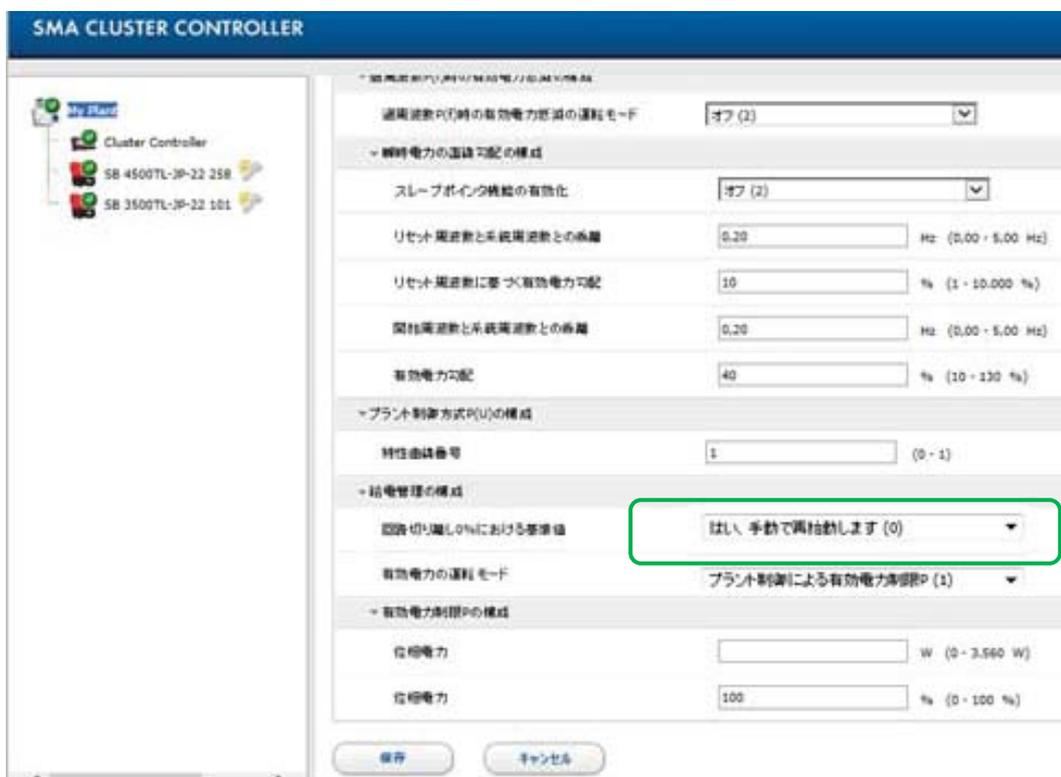
10. 画面左側で「Cluster Controller」をクリックし、「システム管理」タブを選択し、「有効電力」をクリックする。
