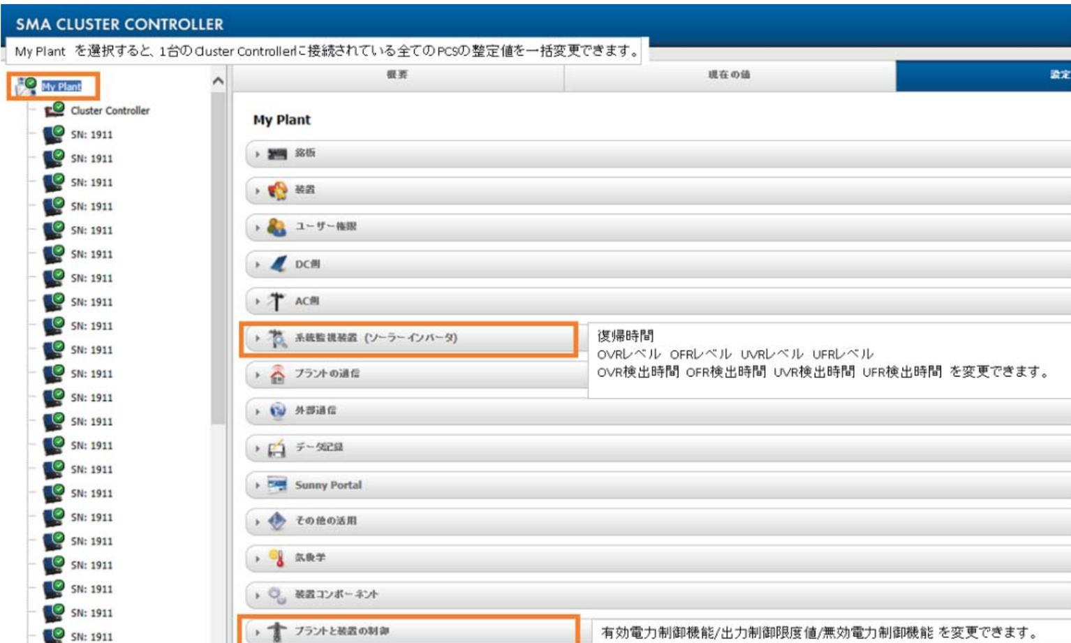
7. 整定値変更のためには『設定』タブ中ほどの『系統監視装置』を選択し、『編集画面』をクリックします。
